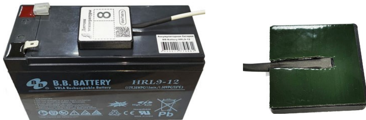
Рисунок 5 - Фиксирующая пластиковая наклейка на термосенсор
